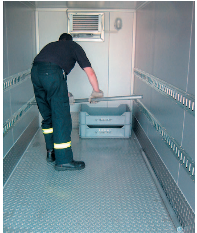
Innenansicht des Feuerwehrranhängers Versorgung: Mithilfe der Schwerlast-Absperrstangen und entsprechender Verankerungen kann das Transportgut sicher verladen werden.
