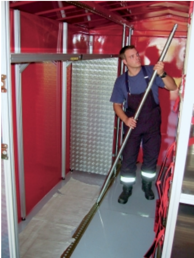
Bild 7 Blick in den AB-Betreuung. Mittels Schwerlastregalen und variablen Absperrstangen können beispielsweise Tische und Bänke transportiert werden.
